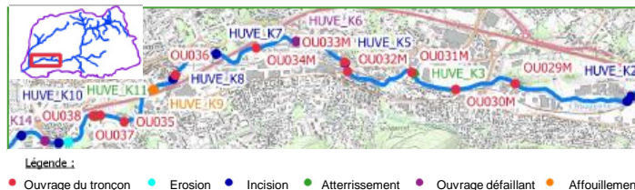
Ouvrages et désordres ponctuels relevés sur le tronçon de l'Huveaune, de Saint Menet à l'Hippodrome Pont-de-Vivaux (Marseille)
