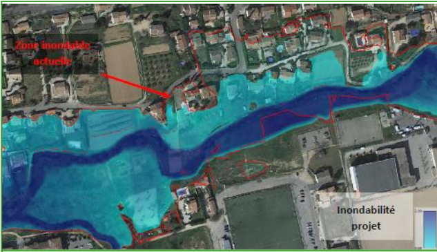
Modélisation de l'impact du projet d'aménagement sur les écoulements pour une crue d'occurrence cinquantennale (ayant une probabilité d'apparition sur une année de 1/50), Après aménagement, la crue cinquantennale est ramenée au niveau décennal actuel.
