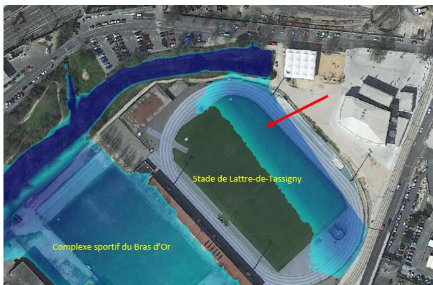
Figure 35 : Début de l'inondation du stade de Lattre de Tassigny (Q = 130 m 3 /s)
