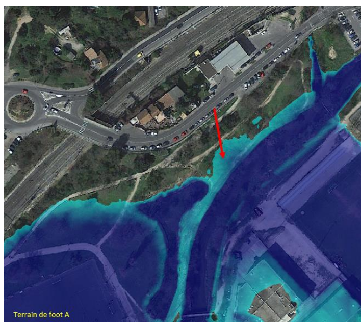
Figure 41 : Début d'inondabilité du secteur de promenade en amont des équipements sportifs ( Q = 200 \text{ m}^3/\text{s} )
