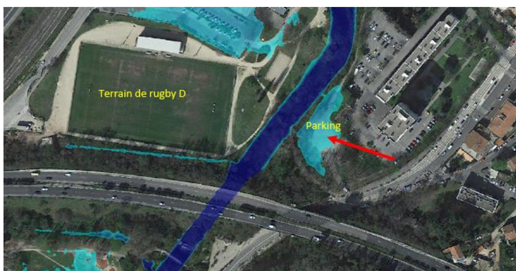
Figure 34 : Risque d'inondabilité par remontée d'eaux dans le réseau pluvial sur le parking en amont de l'A50
