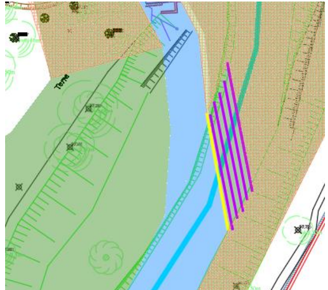
2 ème Raccordement du lit dérivé au lit actuel
